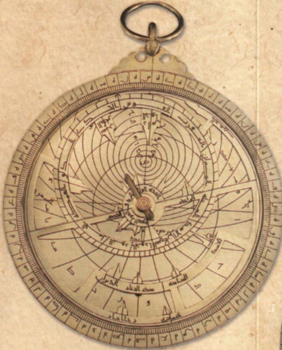
Modelimiz: Pirinç, hâkkedilmiş. Kulplu ve asma halkalı ana 130 mm. çapında. 21°/24°; 30°/31°; 34°/36°; 37°/39° enlem dereceleri için dört iç disk. Ağ 17 yıldız gösterme ucuyla birlikte. Nişangâhlı çift ibre arka tarafta (Envanter No: A 2.14).
