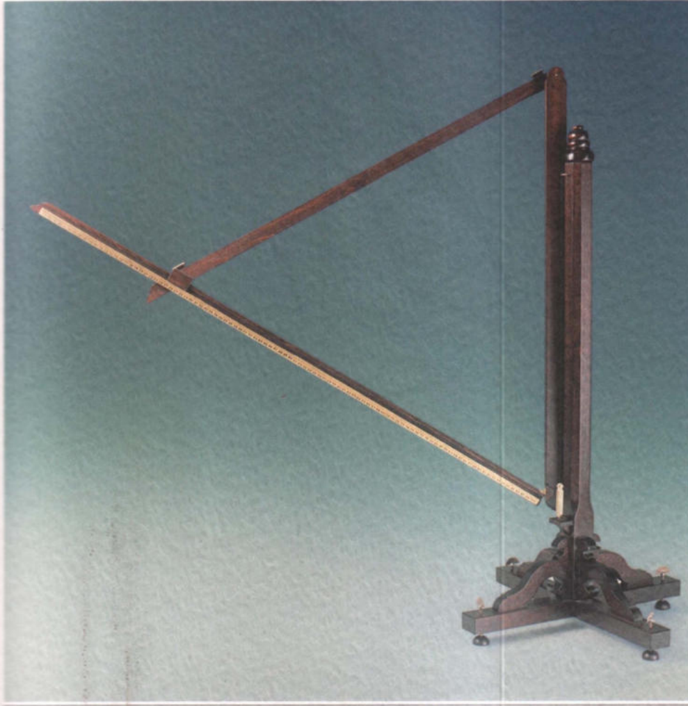
Modelimiz: Ölçek yaklaşık 1:2. Nişangâh uzunluğu 1 m. Eskitilmiş sert ağaç. Uzunluk derece taksimatlı pirinç skala. (Ervanter No: A 4.06)
