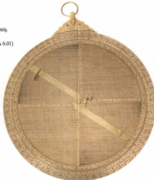
Modelimiz, soldaki: Ana'nın içtarafındaki görünür zic-gravürü (gezegen boylamları) ile birlikte. Sağdaki: Ana bu iç disk ile birlikte, zic gravürü (Gezegen enlemleri).
