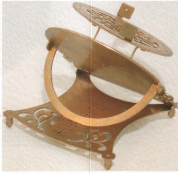
Büyükölük: 10 x 10 cm. Pirinç, hâkkedilmiş. Eğim ayarlanabilir, nişangâh ve takvim dairesi eksensel döndürülebilir. (Envanter No: B 2. 11)
