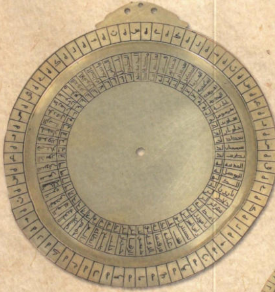
Modelimiz: Pirinç, asitle işlenmiş. Matris 130 mm çapında. Ağ, açt celveli ve iç disk yok. (Envanter No: A 2.26)
