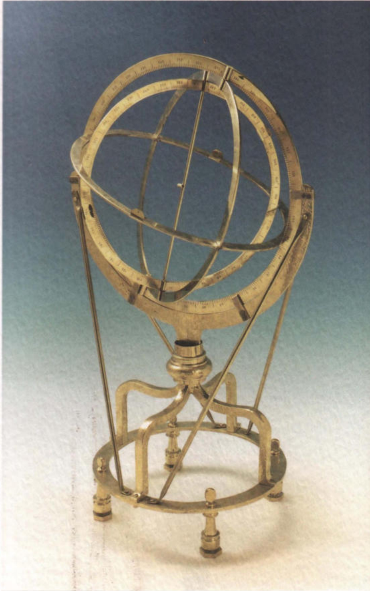
Ölçek 1:4. Çap 50 cm. Piring, hâkkedilmiş. Bütün halkalar her iki tarafı hâkkedilmiş derece taksimatına sahip. (Envanter No: A 4.10)
