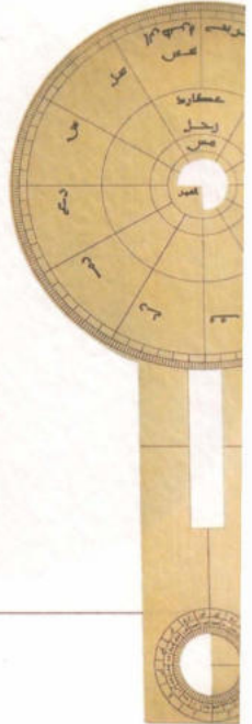
el-Hâzin'in ekvatoryumunun hareketli parçaları, Srinagar, Research Library, Kaschmir (No: 5881) yazmasına dayanarak yapılmıştır. Piring, hâkkedilmiş. Çap 96 ve 124 mm.
