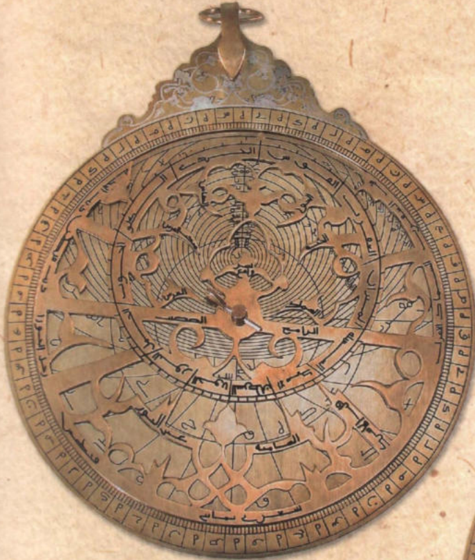
Modelimiz: Pirinç, hâkkedilmiş. Çap 183 mm. 4 iç disk. Nişangâhlı aç cetveli. (Envanter No: A 232)
