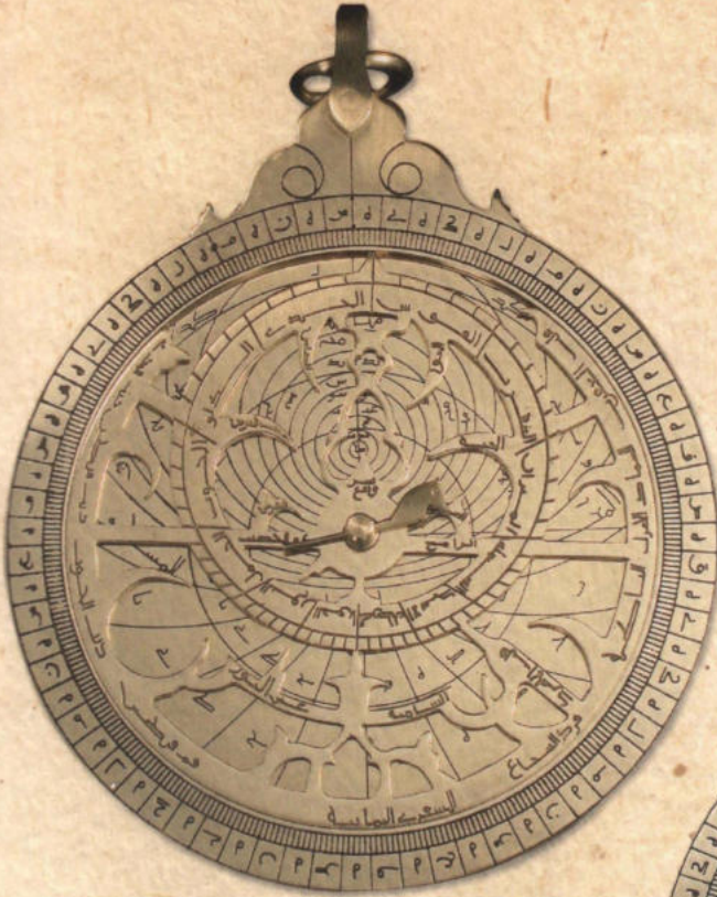
Modelimiz: Piring, hâkkedilmiş. Kulplu ve asma halkalı ana, dış çap 120 mm. 33°/36° ve 72° enlemleri için 2 iç disk. (Envanter No: A 3.33)
