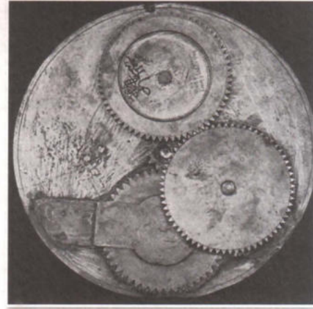
Muhammed b. Ebî Bekr el-İşfehâni'nin aletinin dişli çark mekanizması
